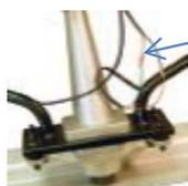
6 3. Соедините разъемы проводов (6) дистанционного зажигания (установлен на ручке управления) с соответствующими разъемами на проводах двигателя.
