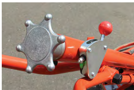
Регулировка угла лопастей
